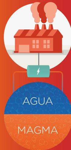
Las centrales geotérmicas se emplazan sobre los **yacimientos geotérmicos**, donde el magma calienta un acuífero.
